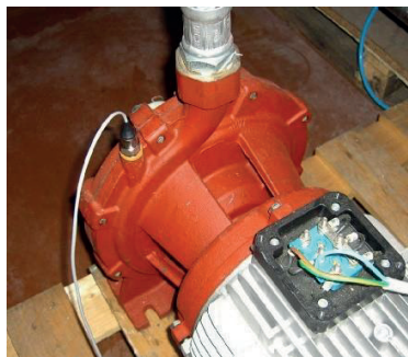
Obrázek 5: Příklad nasávacího otvoru na výtlaču čerpadla s připevněným snímačem
